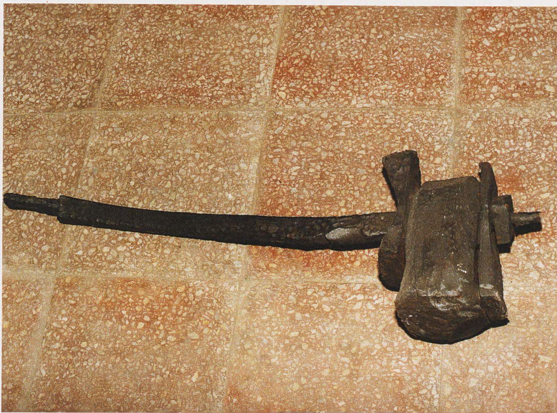
2. Młot od dzwonu zegarowego z wieży niższej kościoła Mariackiego, przekazany wraz z kilkoma innymi elementami instalacji do Archiwum Akt Dawnych Miasta Krakowa 1 września 1938 r. przez Komendę Straży Ogniowej. Według oceny pracowników Straży, którzy dokonali wymiany tych elementów na nowe (pochodzące z fabryki Zieleniewskiego), stan ich zużycia wskazywał, iż mogły być założone najwcześniej w latach trzydziestych XIX w. Muzeum Historyczne Miasta Krakowa, nr inw. 820-II
