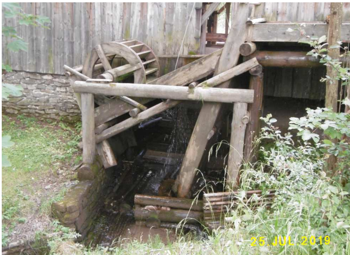
Fot. nr 34. „Wałaska”, koło podsiębierne napędzające mechanizm z jedną piłą.
