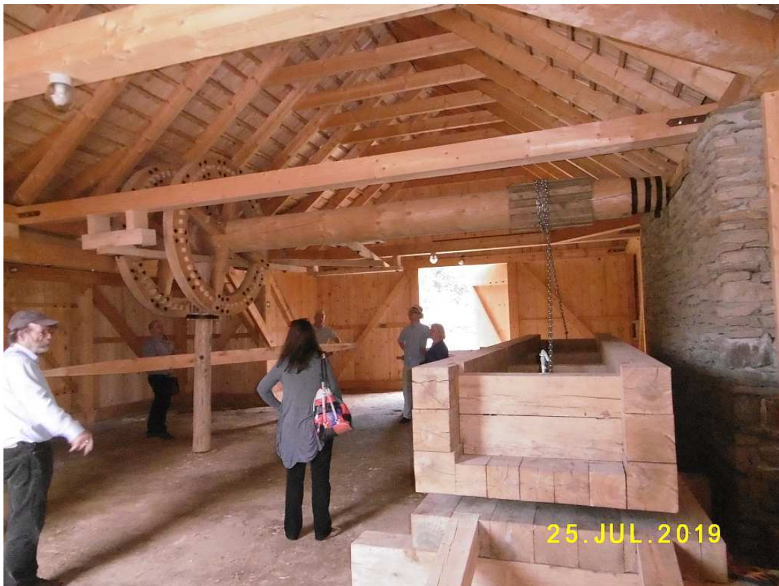
Fot. nr 165 (165-169). Zrekonstruowany magiel, napędzany kieratem, w części gospodarczej kompleksu mieszkalno-gospodarczego z Lipnicy Górnej.
