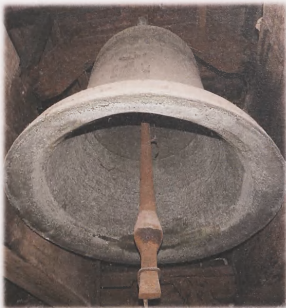
1. Kościół św. Krzyża, dzwon z wieku XV. Średni skład procentowy stopu: Cu – 72,758%, Sn – 15,616%, Sb – 1,906%, Pb – 5,13%, Fe – 1,654%, As – 0,925%, Ag – 0,15%, Zn – 0,208%, Ni – 0,55%, Te – 3,149%. Fot. A. Garbacz-Klempka, 2012
