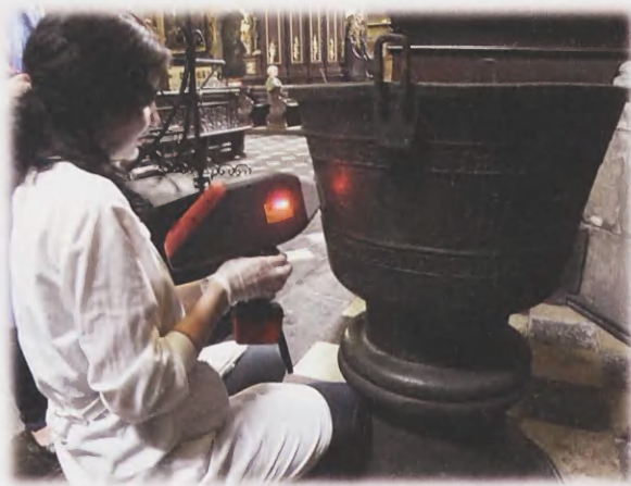
4. Kościół Bożego Ciała, autorka w trakcie badania chrzcielnicy spektrometrem Spectro xSort. Średni skład procentowy stopu: Cu – 0,99%, Sn – 2,0%, Sb – 0,33%, Pb – 97,1%, Fe – 1,1%, As – 0,11%. Fot. A. Garbacz-Klempka, 2012
