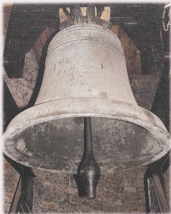
2. Kościół Bożego Ciała, dzwon z wieku XVI. Średni skład procentowy stopu: Cu – 75,744%, Sn – 16,577%, Sb – 1,524%, Pb – 0,718%, Fe – 1,959%, As – 1,32%, Ag – 0,096%. Fot. A. Garbacz-Klempka, 2012
