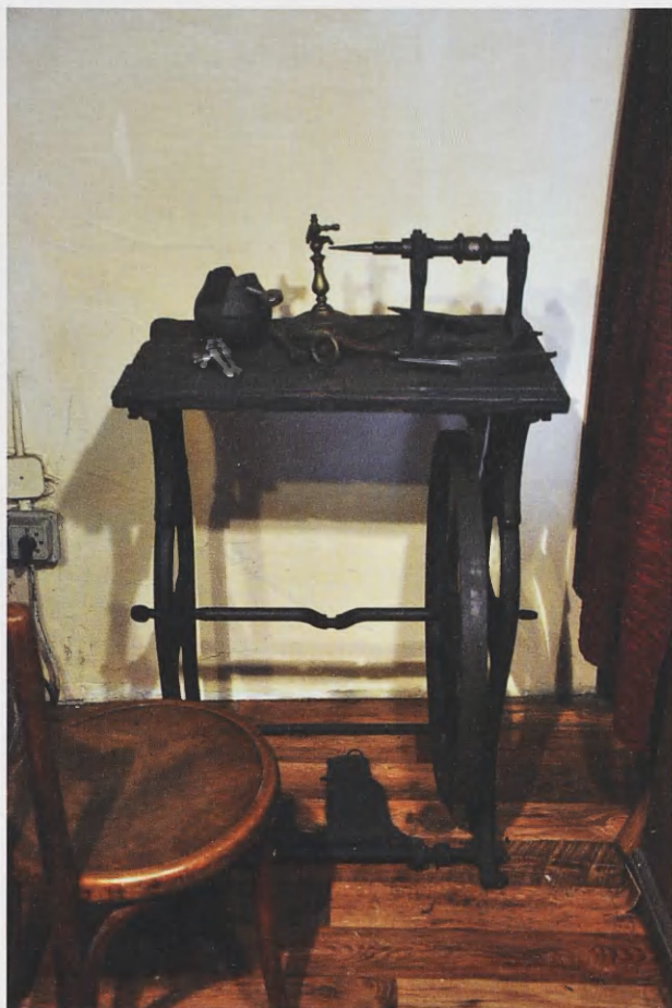
4. Pracownia grawersko-złotnicza Bogusława Stopy w Krakowie: szlifierka nożna (na blacie m.in. kula grawerska, ścisk-kleszcze, palnik, drajła, dwa kowadełka), XIX w. Stan obecny, 2016. Fot. Michał Myśliński
