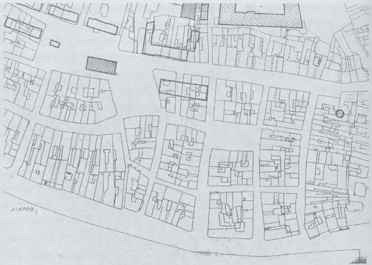
Il. 1. Plan nadodrzańskiej części Starego Miasta w Szczecinie z lat trzydziestych XX w. Cienka linia pokazuje obrys zniszczonej przedwojennej zabudowy, szraf kreskowy i kratkowy zachowane obiekty zabytkowe, grubą linią obrysowano wolnostojące budynki zrealizowane do lat osiemdziesiątych XX w. (źródło: archiwum Zakładu Teorii Architektury, Historii i Konserwacji Zabytków Zachodniopomorskiego Uniwersytetu Technologicznego w Szczecinie).
