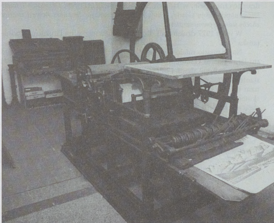
Maszyna drukarska stopcylindrowa z końca XIX w. wyprodukowana w Wiedniu, fot. Tadeusz Śmiałkowski 1998, zbiory: Muzeum Podchalańskie w Nowym Targu.
