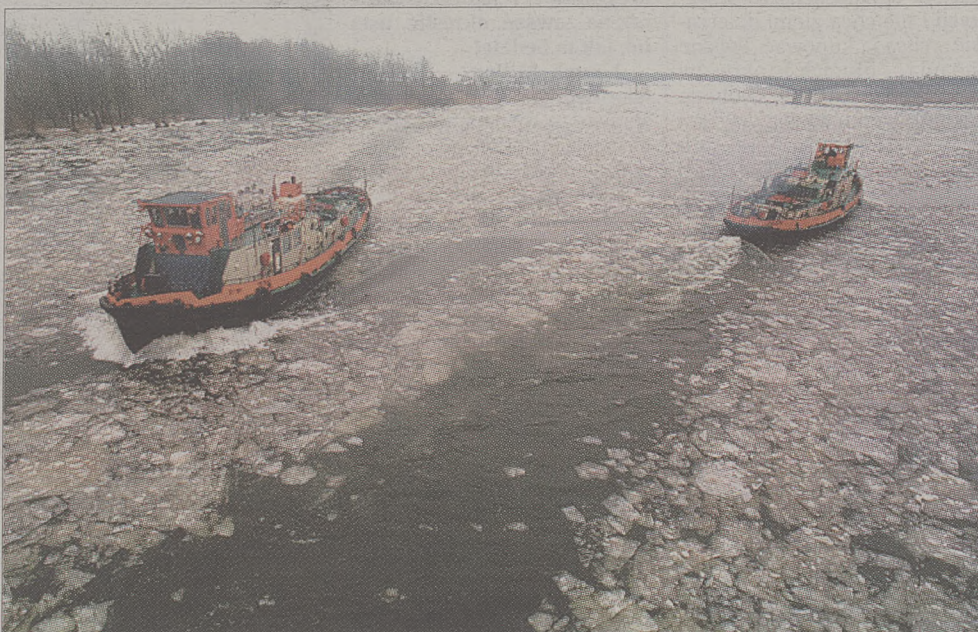
Rozpoczęto akcję kruszenia lodów w dolnym odcinku Odry. Udział w niej biorą polskie i niemieckie lodołamacze. Wcześniej w okolicach Zalewu Szczecińskiego saperzy użyli dynamitu do rozbijania lodowej skorupy.
