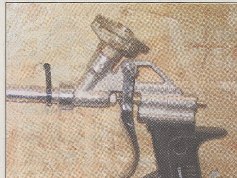
Pistolet półprofesjonalny – demontować i czyścić można jego podstawowe, narażone na zatkanie, elementy
