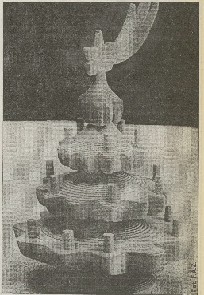
Ta nietypowa choinka ma 2mm wysokości i została „wyrzeźbiona” za pomocą lasera z jednej niewielkiej kropelki sztucznego tworzywa w ośrodku badawczym w Mannheim (Niemcy)
