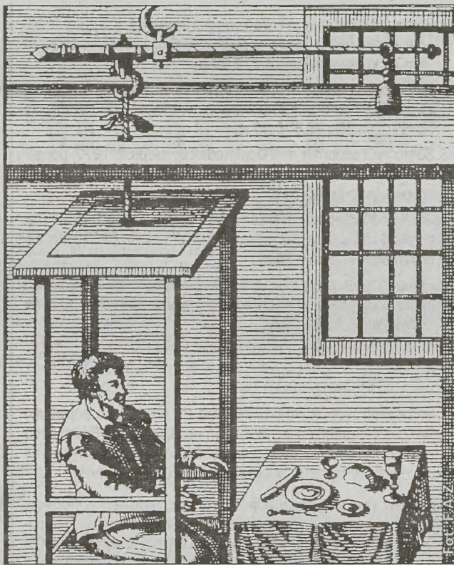
Tę przemysłną wagę do badania przemiany materii w organizmie zbudował włoski lekarz Santorio Santorio na początku XVII w. Za jej pomocą przez trzydzieści lat prowadził na sobie eksperymenty
