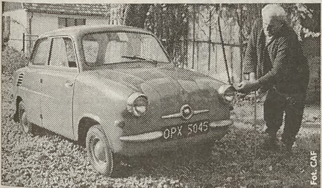
Produkowany niegdyś w PZL w Mielcu „Mikrus”, jeden z pierwszych w Europie mini-samochodów – konstrukcja całkowicie opracowana w Polsce. Ten egzemplarz wyprodukowany został w 1959 roku, wyposażony jest w dwucylindrowy, dwusuwowy silnik o pojemności 295 ccm i mocy 14 KM. Nadwozie wykonane z bardzo odpornej na korozję blachy, używanej także w produkcji samolotów. Od 24 lat jego właścicielem jest pan Gerard Rassman. Auto ma na liczniku ponad 150 tysięcy kilometrów, służy swojemu właścicielowi na codzień, a przed tygodniem użyskoło bez problemów kolejne świadectwo badania technicznego
