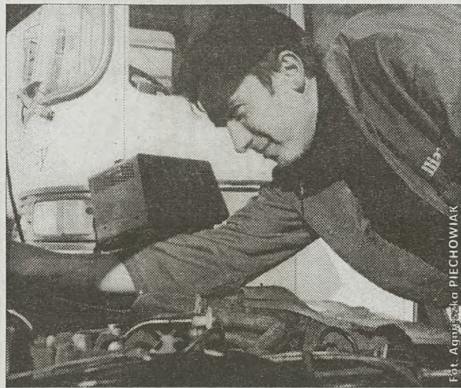
Ryszard Kropornicki sprawdza skuteczność amortyzatorów
