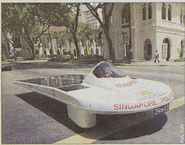
Napędzany energią słoneczną samochód z włókna szklanego „Sun-speed 1” odbywa jazdę próbną po Singapurze. Samochód, który porusza się na trzech kółkach z prędkością 20 km/h i waży około 300 kg, jest pierwszym tego typu pojazdem w Singapurze a został zbudowany przez studentów i wykładowców miejscowej Politechniki
