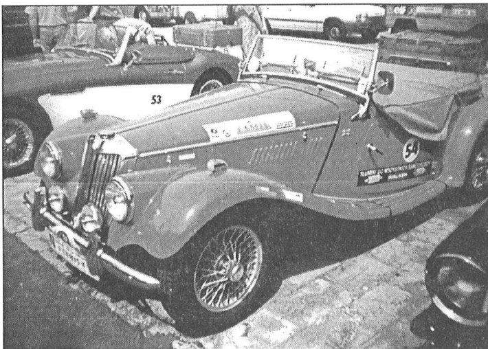
Model MGT produkowany w latach 1949 - 1955 4 - cylindrowy silnik, poj. 1250 cm 3 , moc 54 KM
