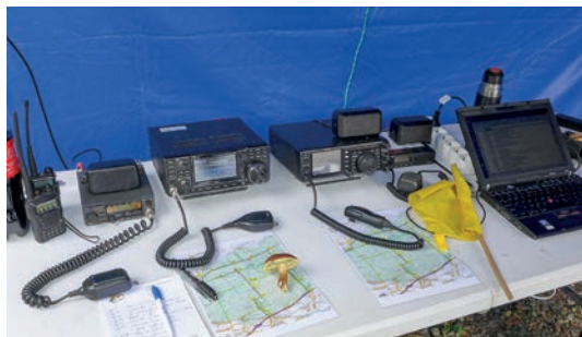
Sprzęt radiowy używany w ćwiczeniach był zasilany z akumulatorów. Mamy tu radiostacje do łączności z patrolami krótkofalowców, służbami medycznymi, Strażą Leśną oraz firmą ochroniarską. Jest również laptop używany do logowania zdarzeń.
