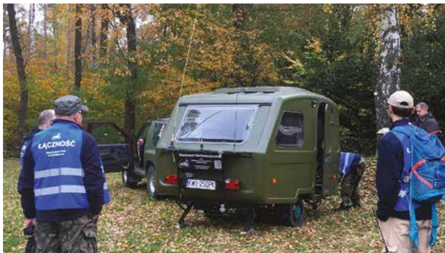
Przyczepa wyposażona w sprzęt radiowy, niezależne zasilanie i ogrzewanie jest znakomitym miejscem koordynowania działań krótkofalców w terenie.
