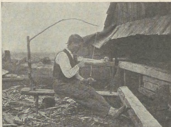
Ryc. 12. Tokarka ręczna do toczenia łyżek. Nowica, pow. gorlicki.
