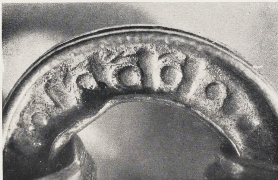
Fig. 8. Ogniwo łańcucha z płytką wewnętrzną (strona prawa), w powiększeniu
