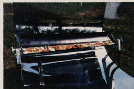
⬆ Grill słoneczny wykorzystuje wielkie składane zwierciadło do ogrzewania wąskiego rusztu. Doskonali w Kalifornii, u nas działa gorzej
