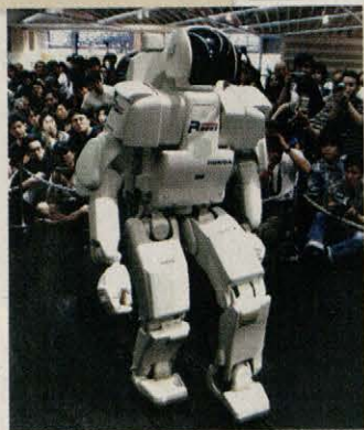
1997 Człekokształtny, dwunożny i chodzący robot, czyli P3 firmy Honda
