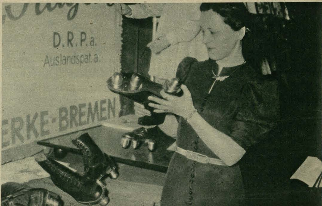
WROTKI O TRZECH ROLKACH. Miłośnicy jazdy na wrotkach — należący przeważnie do młodszego pokolenia — z zadowoleniem przyjmą wiadomość o nowym systemie tego „wehikułu”, pokazywanym obecnie na Targach Lipskich. Oto zamiast czterech rolek wrotki mają trzy, umieszczone w jednej linii. Ułatwia to jazdę a zwłaszcza szybką zmianę kierunku.
