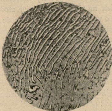
Fig. 7. Stal, zawierająca 0,8% węgla, powoli oziębianą.
