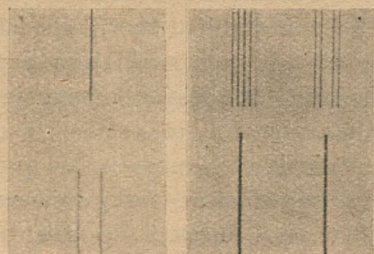
Fig. 1 i 2. 1) Normalna trójka Zeemana (prążek 6438,71 Cd). U góry prążek nieodchylony, spolaryzowany równoległe do pola. U dołu dwa prążki spolaryzowane prostopadłe do pola. 2) Anormalny efekt dwójki sodu (5890,19 i 5895,16). U dołu oba prążki bez pola. U góry szóstka prążka 5890,19 i czwórka prążka 5895,16.
