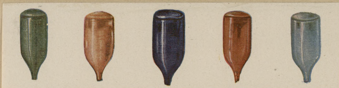
Ryc. 1. Syntetycznie otrzymane kamienie w stanie surowym. Od lewej do prawej: szafiry: zielony, żółty, niebieski, w barwie kwiatu lotosu (podparadża), spinel w kolorze akwamarynu.
