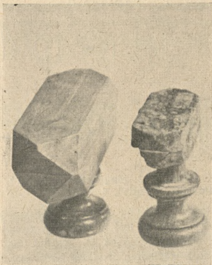
Ryc. 12. Bliźniak ortoklazu według prawa manebachs-kiego (kryształ naturalny i model krystalograficzny)
