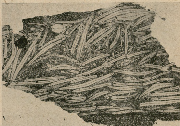
Ryc. 7. Obraz mikroskopowy wapienia numulitowego z eocenu tatrzańskiego. „Kamieniołom Pod Capkami”. Bez analizatora. Pow. 5 ×
