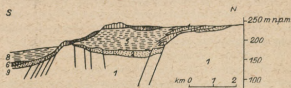
Ryc. 1. Przekrój schematyczny przez południową krawędź Wyżyny Lubelskiej pod Zaklikowem. Po lewej stronie rów podkarpacki. 1 — Kreda, 2 — piaski dolnego tortonu, 3 — żwiry tortonu, 4 — wapienie litotamniowe, 5 — wapienie detrytyczne tortonu, 6 — wapienie serpulowe sarmatu, 7 — wapienie detrytyczne sarmatu, 8 — ily krakowieckie tortonu i sarmatu (wg W. Pożaryskiego nieco zmienione)
