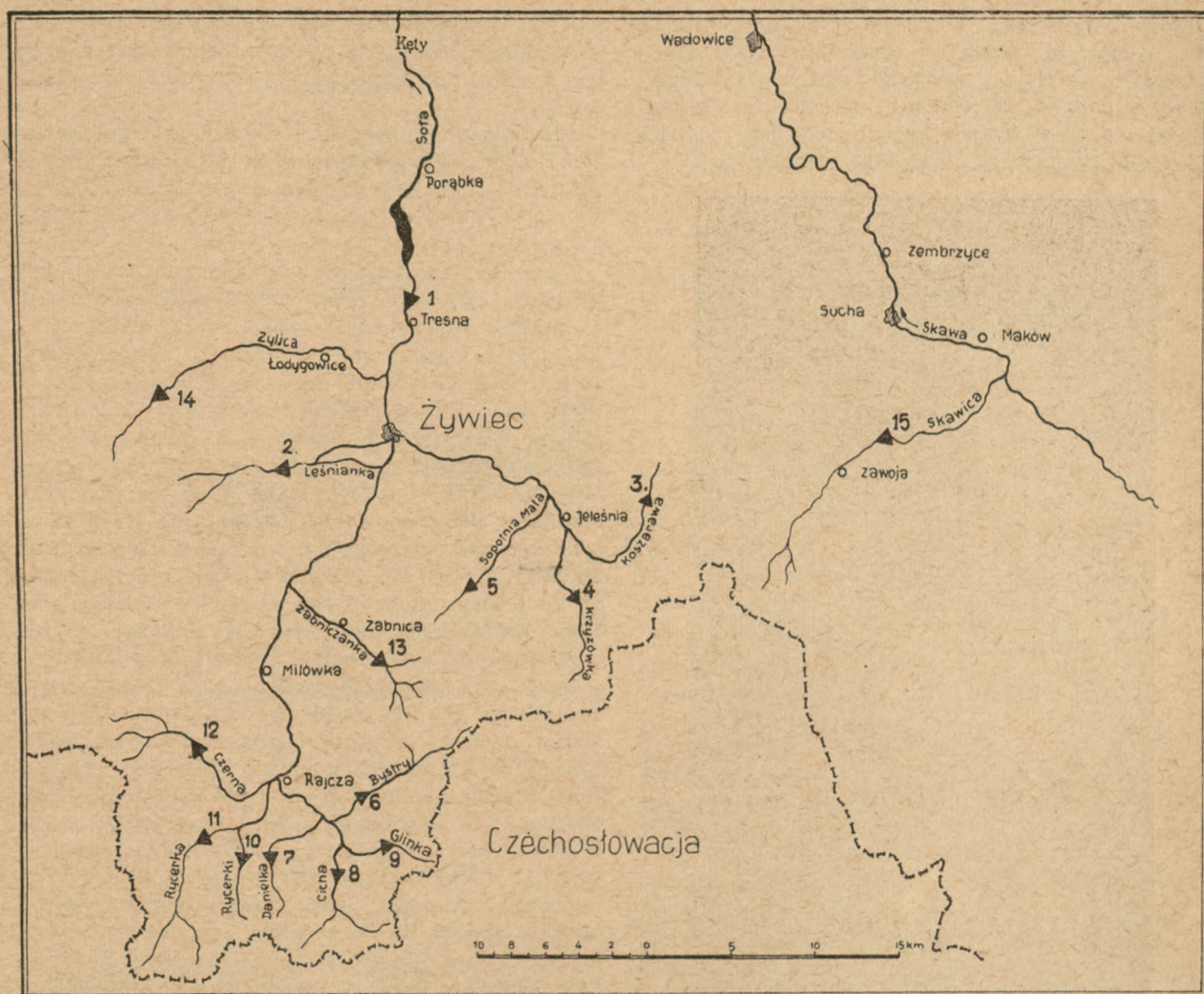
Ryc. 1. Projektowane zbiorniki wodne w Żywiecczyźnie:
