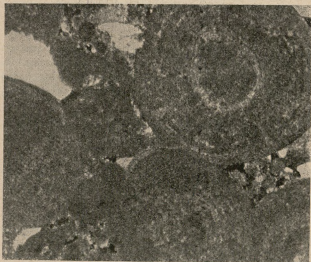
Ryc. 3. Oolity z węglanu wapnia o budowie współśrodkowej. W oolitach tych zanika budowa współśrodkowa i brak budowy promienistej. Pow. ok. 150 \times , jura górna, wiercenie Bartoszyce (woj. olsztyńskie). Fot. K. Radlicz
