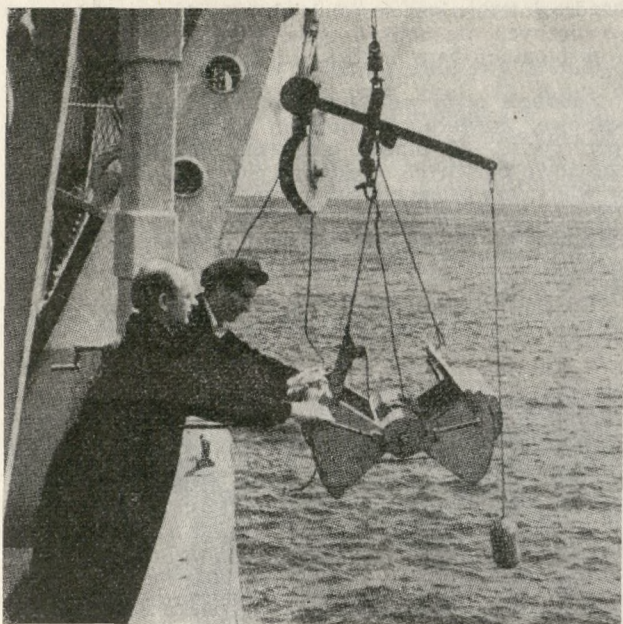
Ryc. 7. Aparat do pobierania prób z dna morskiego
