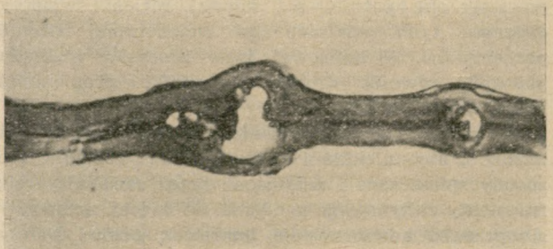
Ryc. 6. Przekroje mikrotomowe dwóch przylegających do siebie części pancerza z widocznymi pomiędzy nimi kanalikami (pow. ok. 370 \times )
