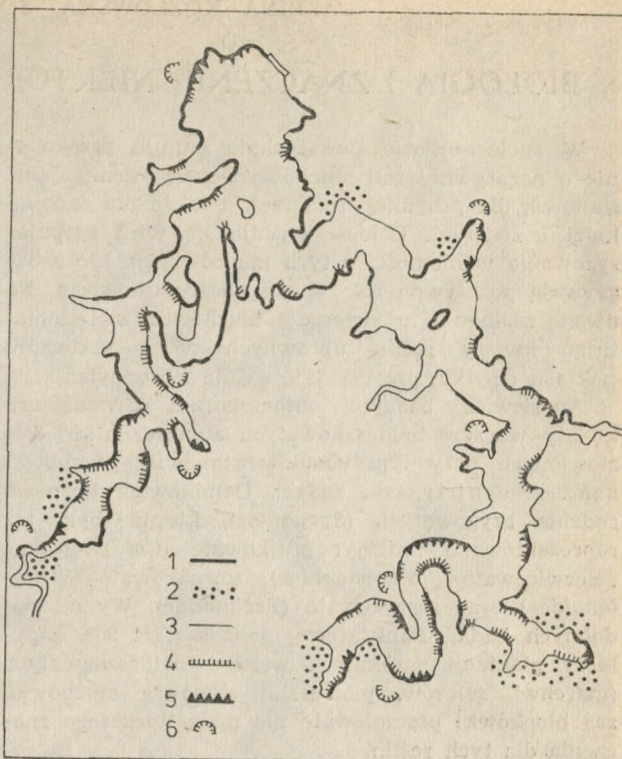
Ryc. 5. Procesy abrazyj i akumulacji brzegowej w zbiorniku Solina: 1 — brzeg abradowany, 2 — brzeg akumulowany, 3 — brzeg niestabilizowany, 4 — wysokość brzegowego stopnia abrazyjnego od 2 do 5 m, 5 — wysokość brzegowego stopnia abrazyjnego powyżej 5 m, 6 — rejon ważniejszych osuwisk i obrywów (wg W. Kieraś, J. Majki i R. Racinowskiego)
