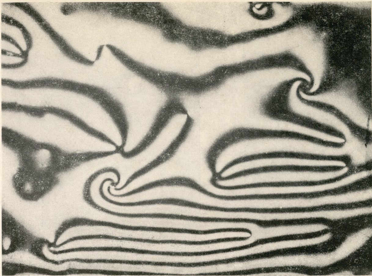
b. Tekstura smugowa w smektycznych ciekłych kryształach. Fot. A. Adamczyk
