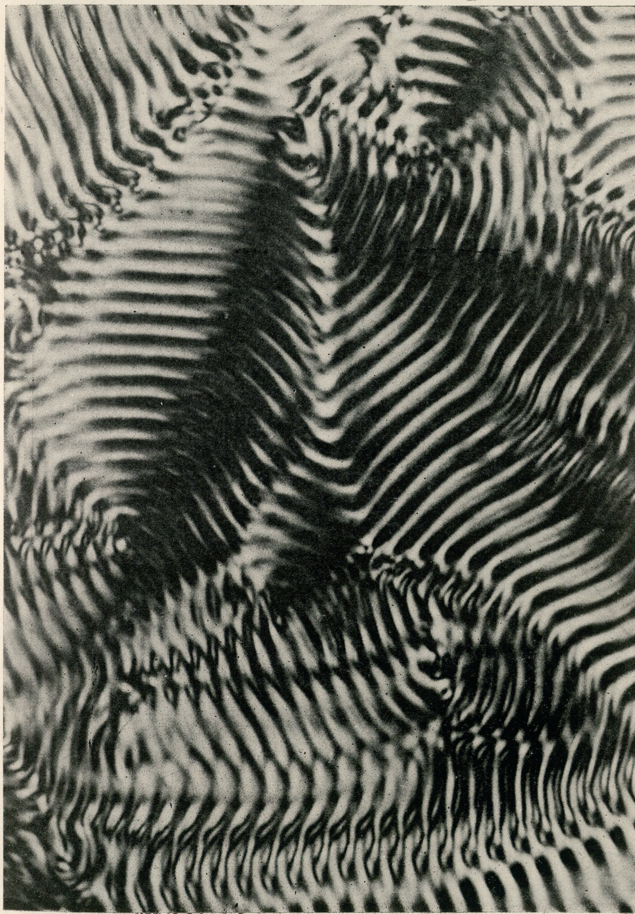
III. STRUKTURY CIEKŁOKRYSTALICZNE: przenikanie się warstw ciekłych kryształów. Pow. 250\times . Fot. A. Adamczyk
