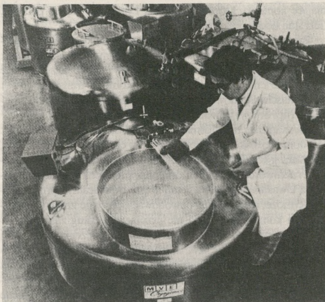
Wymywanie próbek z termosu chłodzonego ciekłym azotem w depozytorni mikroorganizmów
