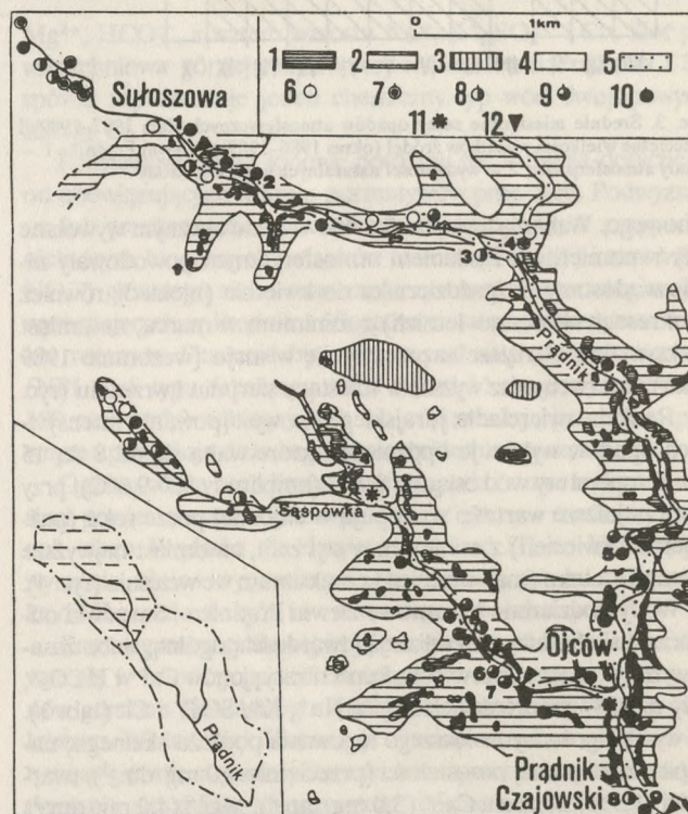
Ryc. 2. Budowa geologiczna, naturalne wypływy wód podziemnych i gruntowych oraz sieć powierzchniowa górnej i środkowej części dorzecza Prądnika (wg S. W. Alexandrowicza i Z. Wilka 1962): 1 - wapienie w skałkach (jura), 2 - wapienie (jura), 3 - gliny (czwartorzęd), 4 - lessy (czwartorzęd), 5 - aluwia (czwartorzęd), 6 - źródła o wydajności: poniżej 0,1 \text{dm}^3 \cdot \text{s}^{-1} , niektóre funkcjonujące okresowo, 7 - od 0,11 do 1,0 \text{dm}^3 \cdot \text{s}^{-1} , 8 - od 1,1 do 5,0 \text{dm}^3 \cdot \text{s}^{-1} , 9 - od 5,1 do 10,0 \text{dm}^3 \cdot \text{s}^{-1} , 10 - powyżej 10,1 \text{dm}^3 \cdot \text{s}^{-1} , 11 - stacje meteorologiczne: dolina Saspówka-Warzechówka 360 m n. p. m., zboczowa Prądnik-Berło 350 m n. p. m., 12 - lokalizacja punktów poboru wody do analiz chemicznych i przekroje pomiarowe
