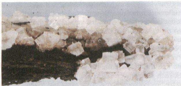
Ryc. 1. Kryształy soli kamiennej na stalowej linie. Fot. H. Pitera
